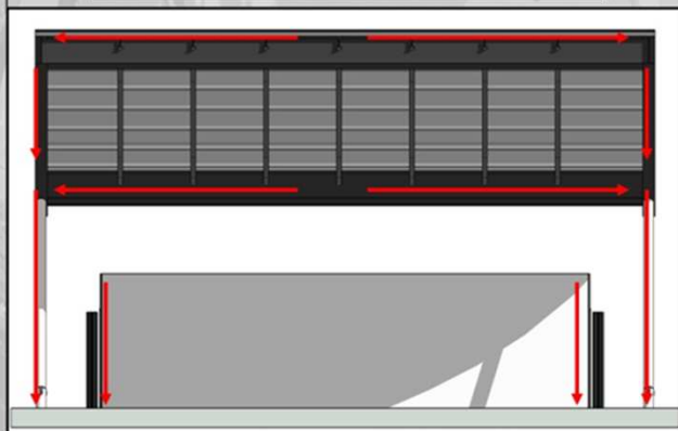
ESQUEMA DE DISTRIBUCION DE CARGAS
