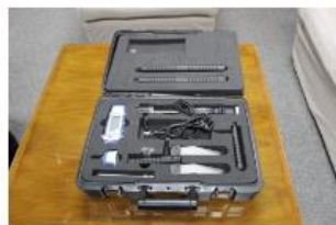
MEDIDOR DE NIVEL DE HUMEDAD EN MADERA ASERRADA, CARÓN, PAPEL, MATERIALES ENDURECIDOS COMO YESO, HORMIGÓN Y MORTERO. ADEMÁS MIDE LA TEMPERATURA AMBIENTE Y LA HUMEDAD
